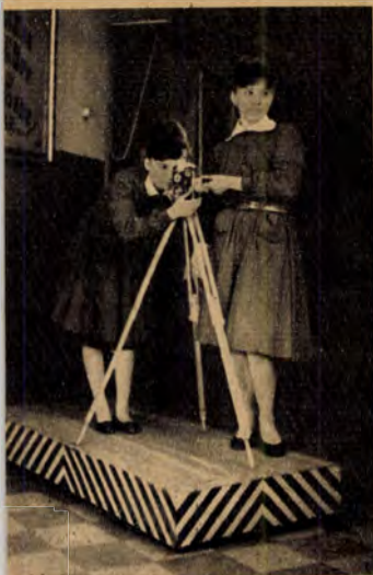
A felvevőkocsi nagysága 170×80×20 cm. Belsejébe 4 csapágyazott kereket építettünk, felső borítása műanyag.
